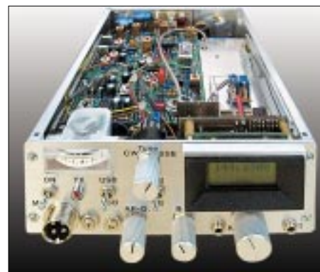
Die Hohentwiel -Modifikation von DF5SL kommt mit Fertigungspulsen aus, erreicht F = 1,1 dB und verfügt über eine Digitalskala.
